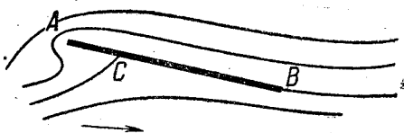
Фиг. б. Обтекание пластинки по схеме Жуковского-Чаплыгина.
